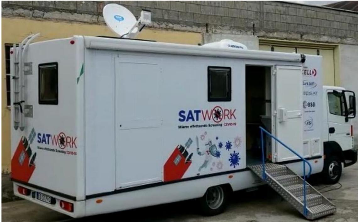
**Unità di campo rilocabile** (proprietà **Euro.Soft**), dotata di gateway locale di TLC multicanale (SAT, WiFi, LoRA, LTE, ecc.). WireLess Connection (WBDL) - realizzata da **MEDINOK** – per connettibilità wireless a larga banda (up to 2,5 Gbps) nel range 500mt tra il Laboratorio mobile con il near-end ed il far-end WBDL.
